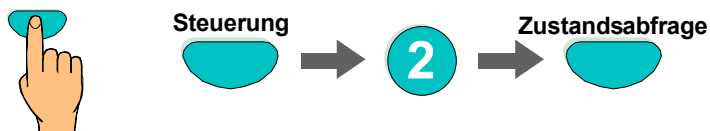
Abb. 39: Zustandsabfrage des Relais 2 (Beispiel)
